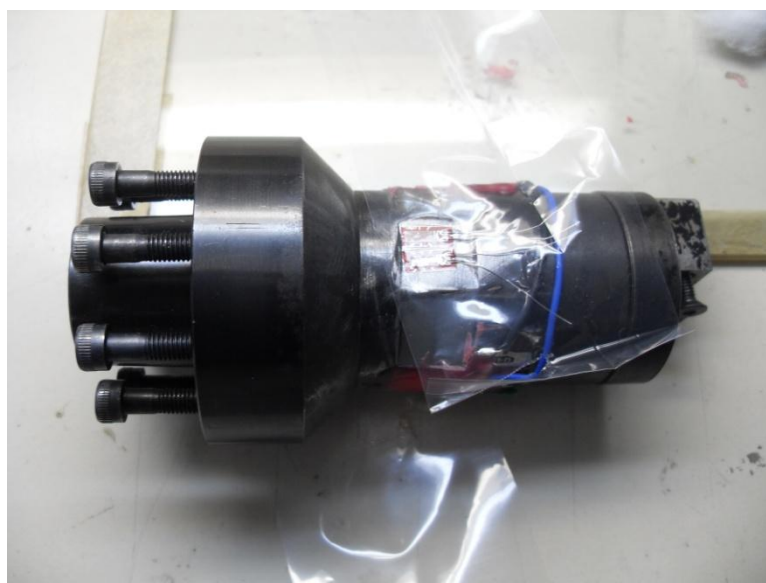
Figura 33 - Extensômetro coberto com a folha de teflon.
