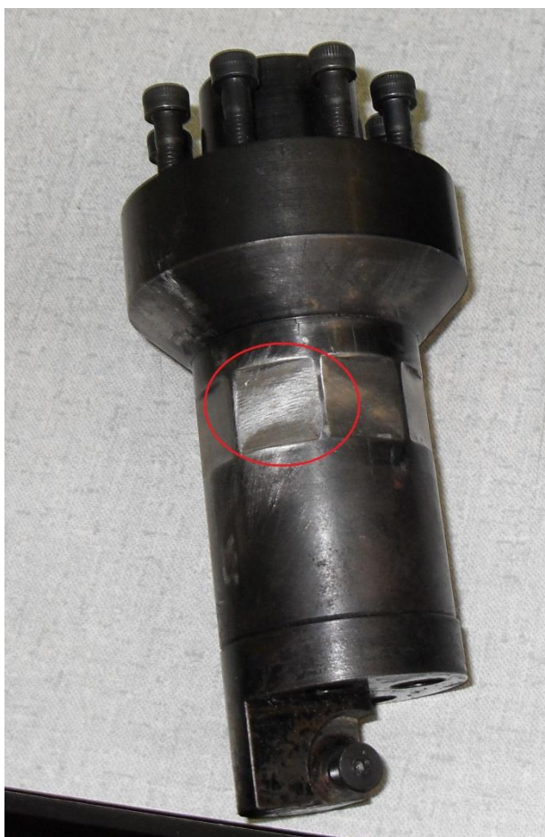
Figura 25 - Porta ferramenta com célula para extensômetro em destaque.
